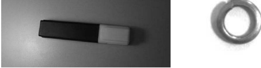
图 4.2: 光线引起的灰度变化。左图为光的缓变引起的灰度变化; 右图为遮挡造成的灰度变化
