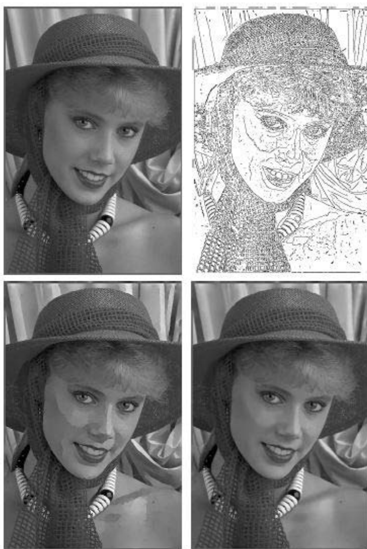
图 4.17: 基于边缘的图像编码及其重构。左上: 原始图像; 右上: 边缘图像 (其它参数无法显示); 左下: 解方程得到的图像; 右下: 重构图像。源自 [66]
